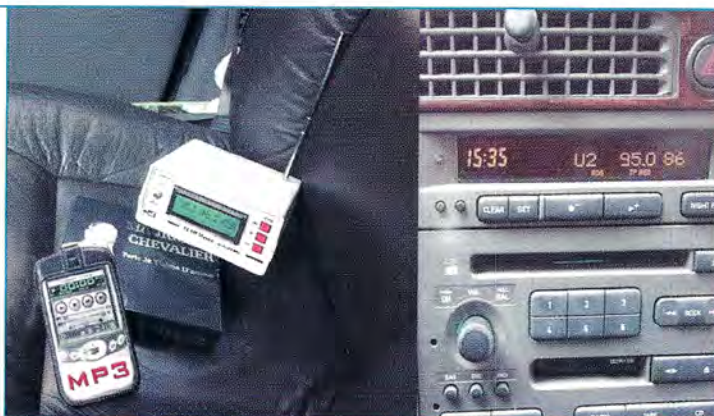
Fig.1 Collegando a questo Trasmettitore FM il vostro lettore MP3 potrete ascoltare nell'impianto stereo dell'auto o del camper i vostri brani musicali preferiti.
